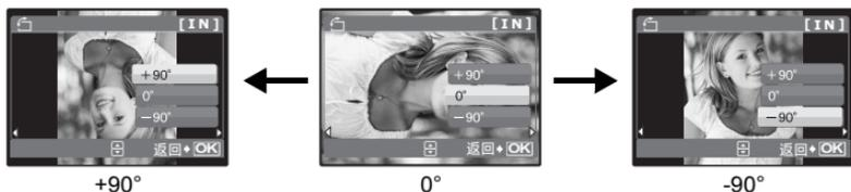
使用  $\triangleleft$  选择图像，并使用  $\triangleup$  选择 [+90°] / [0°] / [-90°] 旋转图像。可以连续旋转几张图像。
