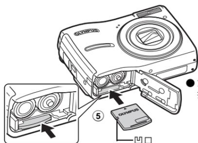
● 如图所示对正插卡并将其笔直插入插槽中。将插卡插入到位。
