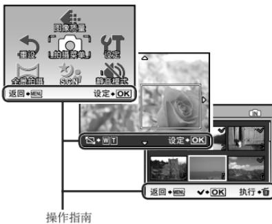
! 在光线微暗的情形下操作照相机时，在拍摄模式中按住  $\text{W}^*/\text{T}$  钮显示向导以指示按钮的位置。
