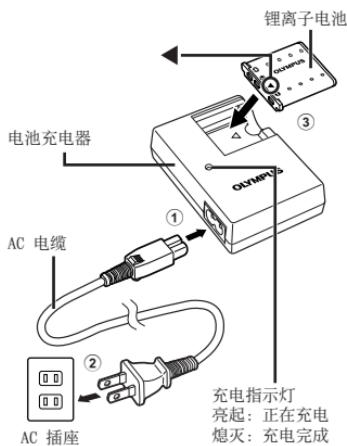
**!** 您得到的电池只剩部分电量。在使用之前，请务必对电池充电，直到充电指示灯熄灭（约需 5 小时）。
