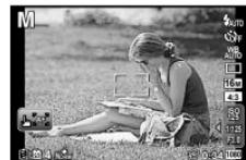
按  $\blacktriangleleft$  之后，您可以使用  $\blacktriangleleft \blacktriangleright$  选择光圈值、快门速度或ISO感光度，并使用  $\triangle \nabla$  改变值。
