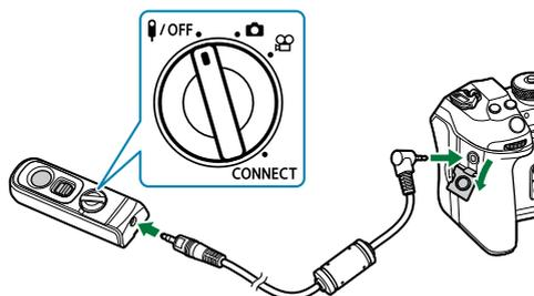
将遥控器的模式拨盘旋转至 **OFF**，然后通过附带的电缆将遥控器连接到相机上。
