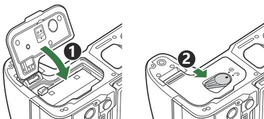
① 使用照相机前请确保电池舱盖已合上。
