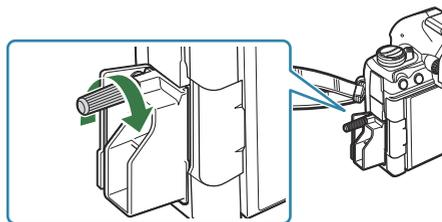
**3. 将电缆夹卡在电缆上，然后将电缆夹安装至背带。**
