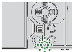
① 如果发生充电错误，电池充电指示灯将闪烁。断开并重新连接 USB 电缆。
