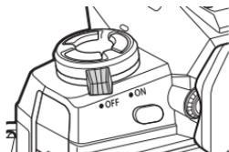
2 如图所示(①, ②)旋转存储卡舱盖锁便可打开存储卡舱盖(③)。
